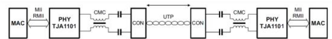
图 4.3 车载以太网典型网络连接示意图
