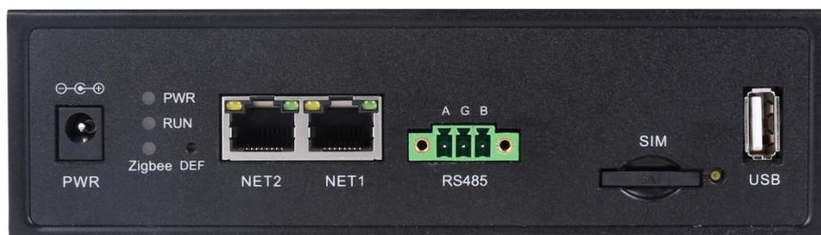
图 2.1 GZ32M-I 系列 Zigbee 网关正面接口图
